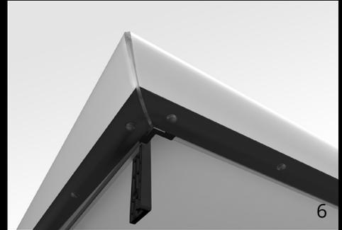
**5-6** Befestigen Sie die Projektionsfolie indem Sie bei einer Ecke je einen vertikalen und horizontalen Folielhaken in den Eckenclips einhängen. Wiederholen Sie diesen Schritt entsprechend der Reihenfolge in Abbildung **7**.
